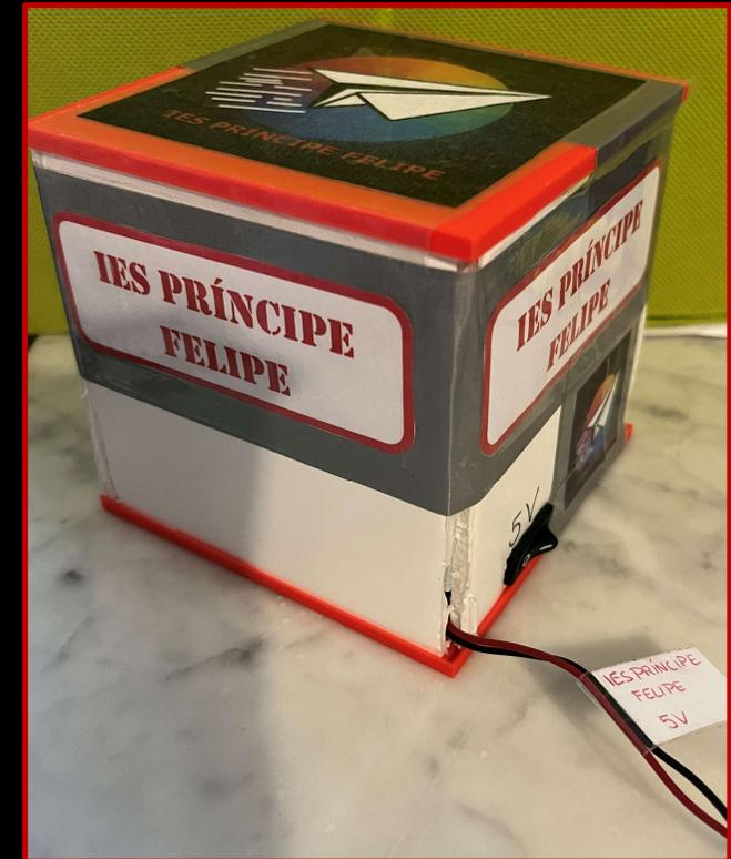
**Caja de 1 litro, con interruptor accesible, led para funcionamiento, 40 cm de cable a 5V marcado**
