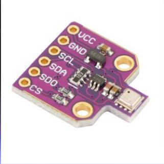
SENSOR BME680, SE HA USADO PARA MEDIR LA PRESIÓN, HUMEDAD, TEMPERATURA Y EL ÍNDICE EN LA CALIDAD DEL AIRE
